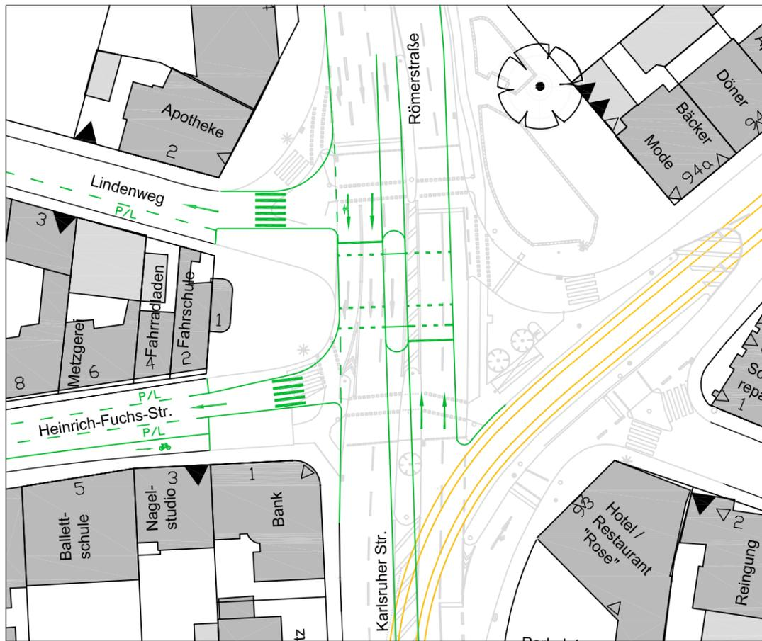
**Variante K1** Verkehrsführung wie heute mit zentrierter Querung für den Fuß- und Radverkehr
