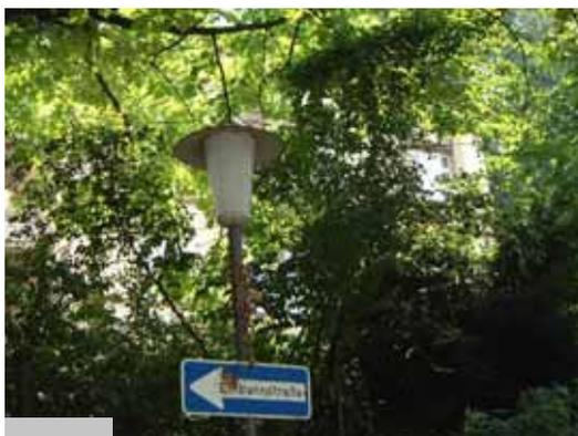
Pilzleuchten in der Friedrich-Ebert-Anlage in verschiedenen Varianten, Lichtpunkthöhe ca. 3,00m in verschiedenen Varianten
