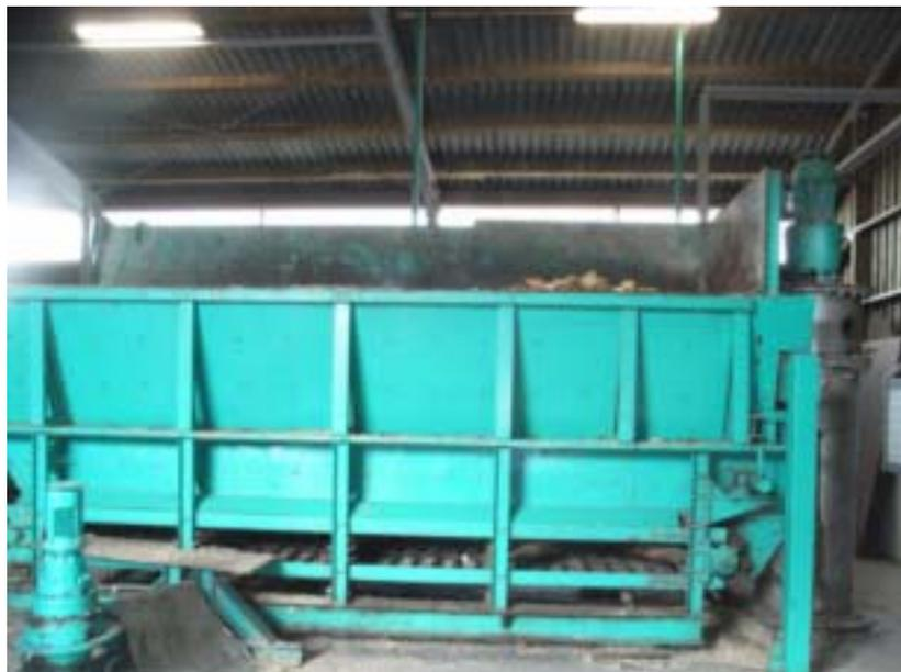
Abbildung 3-4: Feststoffdosierer
