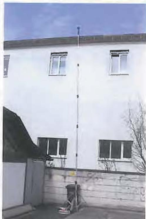
Abb. 5: Messung des Magnetfelds in normaler Höhe und Höhenmessung auf 7,5 m
