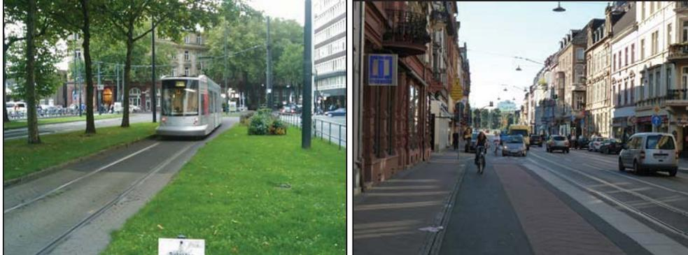
Abbildung 2: Beispiel einer Trasse im eigenen Bahnkörper (links) und straßenbündig (rechts)
