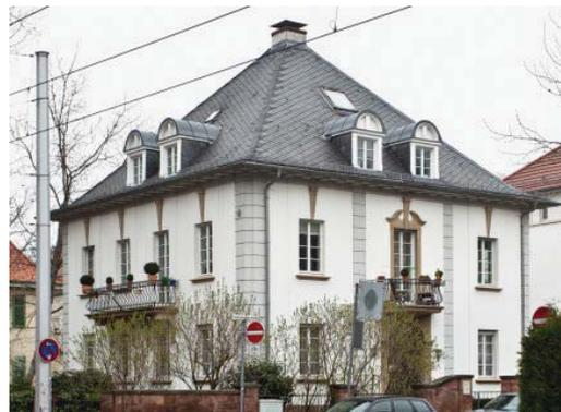
Abbildung 33 – keine bodentiefen Öffnungen, untergeordnete stehende Fensterformate, Einzelbalkone
