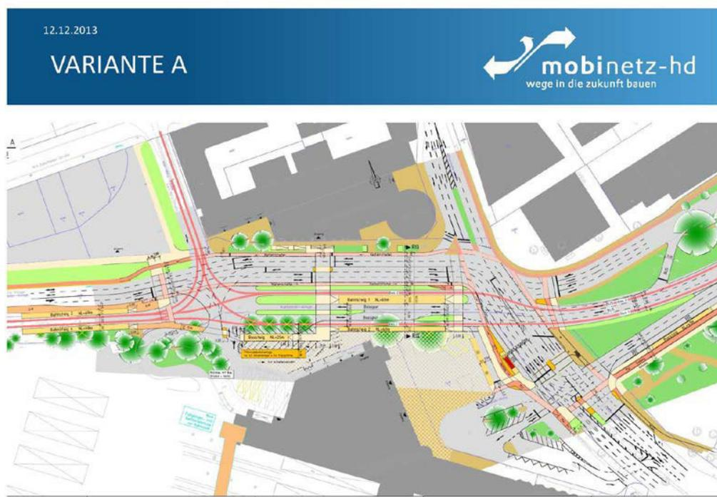
ÖPNV: Abwicklung des Straßenbahnverkehrs über zwei Gleise mit einem Mittelbahnsteig, der eine Entflechtung von Bus- und Straßenbahnverkehr erlaubt sowie einem räumlich getrennt liegenden Bussteig westlich der Haltestelle.
