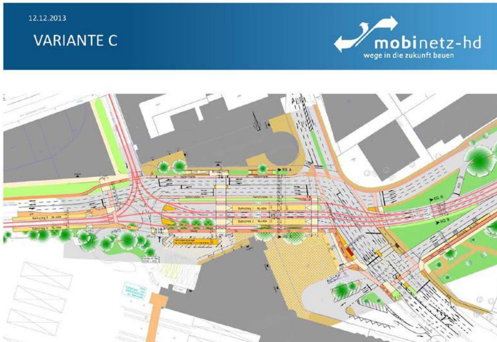
ÖPNV: Die Abwicklung des ÖPNV über zwei Mittelbahnsteigen mit vier Gleisen. Der Busverkehr würde auch über diese Steige abgewickelt. Eine Entflechtung des Bus- und Straßenbahnverkehrs sei aufgrund der vier Bahnsteigkanten möglich.
