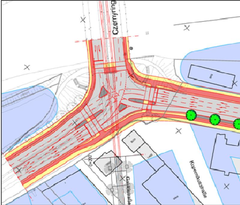
**Bild 39:** Lageplan K112 Czernybrücke, Variante 2-spuriger Linkseinbieger
