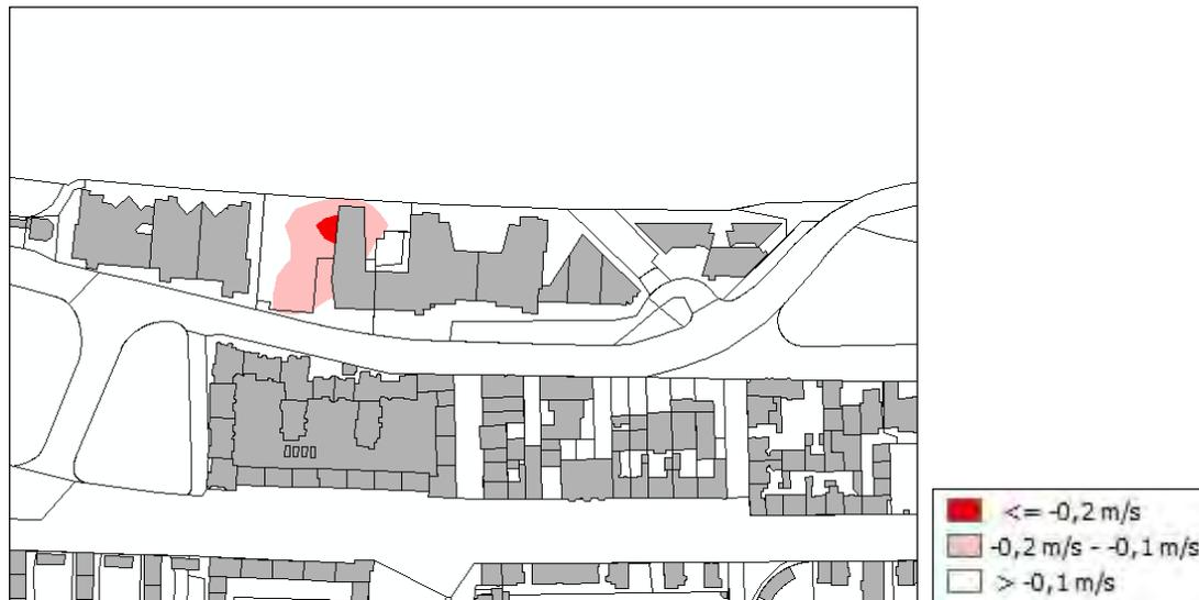
**Abb. 7:** Differenz der Windgeschwindigkeit zwischen der Prognosesituation und dem Istzustand in m/s.
