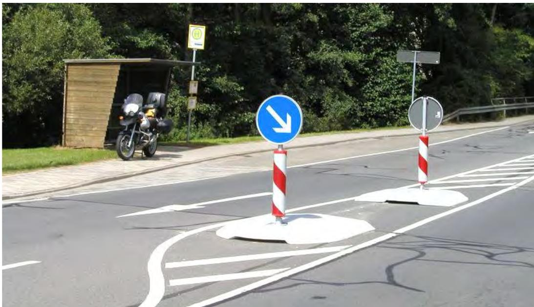
**Abbildung 4:** Provisorische Mittelinsel aus Recycling Kunststoff
