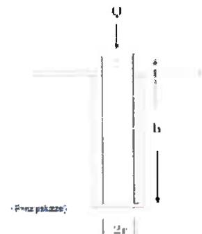
Verdichtung während der Bohrung kann zu veränderten Versickerungsraten führen!
