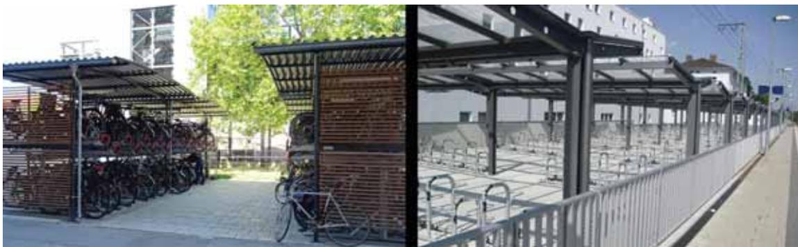
Abbildung 44 Beispiel überdachte Fahrradabstellanlagen mit Möglichkeit zum Rahmenanschluss
