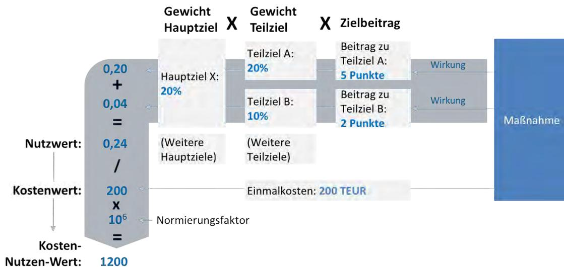
Abbildung 5: Ableitung des Kosten-Nutzen-Wertes einer Maßnahme
