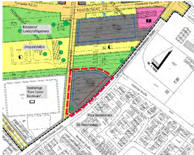
Gemäß der aktuellen Ausarbeitung werden aufgrund des Verkehrslärms die Orientierungswerte für ein Mischgebiet an den direkt zur Pleikartsförster Straße zugewandten Ost-, Nord- und Südfassaden überschritten. An den übrigen Fassaden des Bauvorhabens in Richtung Schlosskirschenweg werden diese eingehalten.
