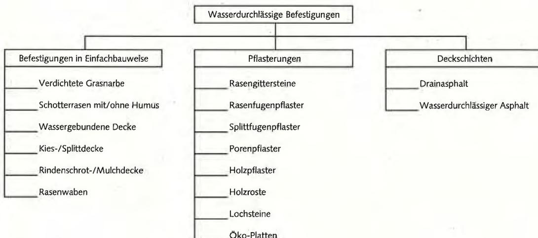
**Abbildung 6:** Wasserdurchlässige Flächenbefestigungsarten
