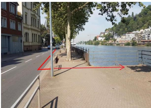
Die Trassenführung erfolgt über im Erdreich verlegte Leerrohre NW 110 mit Unterbrechung an den Biegepunkten ohne Kabelzugschächte.
