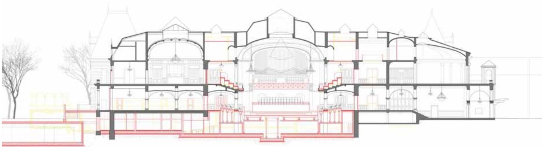
**Platzbedarf Lüftungstechnik** Längsschnitt mit Technikkeller
