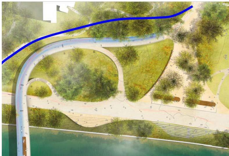
Eine derartige Führung würde es erlauben, dass die Radbrücke eine geringere Höhe erreichen muss, damit würde sich auch die Rampe auf der Nordseite verkürzen und auch die Steigung geringer ausfallen.
