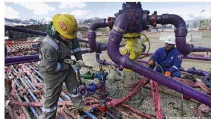
Fracking boomt in den USA. Mit Hilfe von Chemikalien und hohem Druck wird Gestein unterirdisch aufgesprengt und dabei Öl und Erdgas, das hauptsächlich aus Methan besteht, freigesetzt. Ein großes Problem bei dieser Methode ist, dass das Gas nicht komplett aufgefangen wird und deshalb viel klimaschädliches Methan in die Atmosphäre entweicht.
