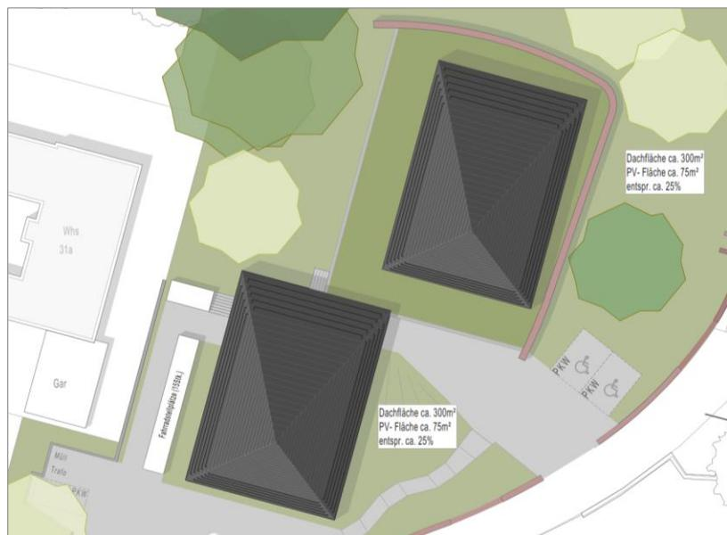
Variante Zeltdach mit integriertem PV-Band
