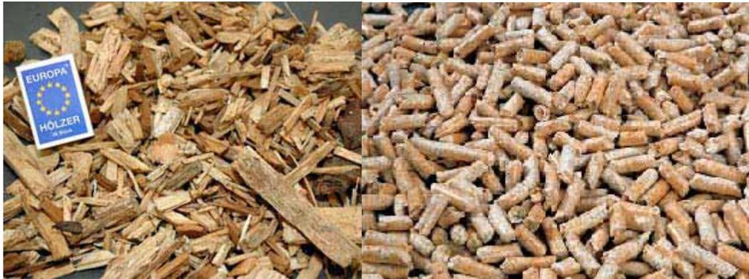
Abb. 29: Holz hackschnitzel (links) und Holzpellets (rechts).
