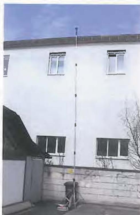
Abb. 5: Messung des Magnetfelds in normaler Höhe und Höhenmessung auf 7,5 m
