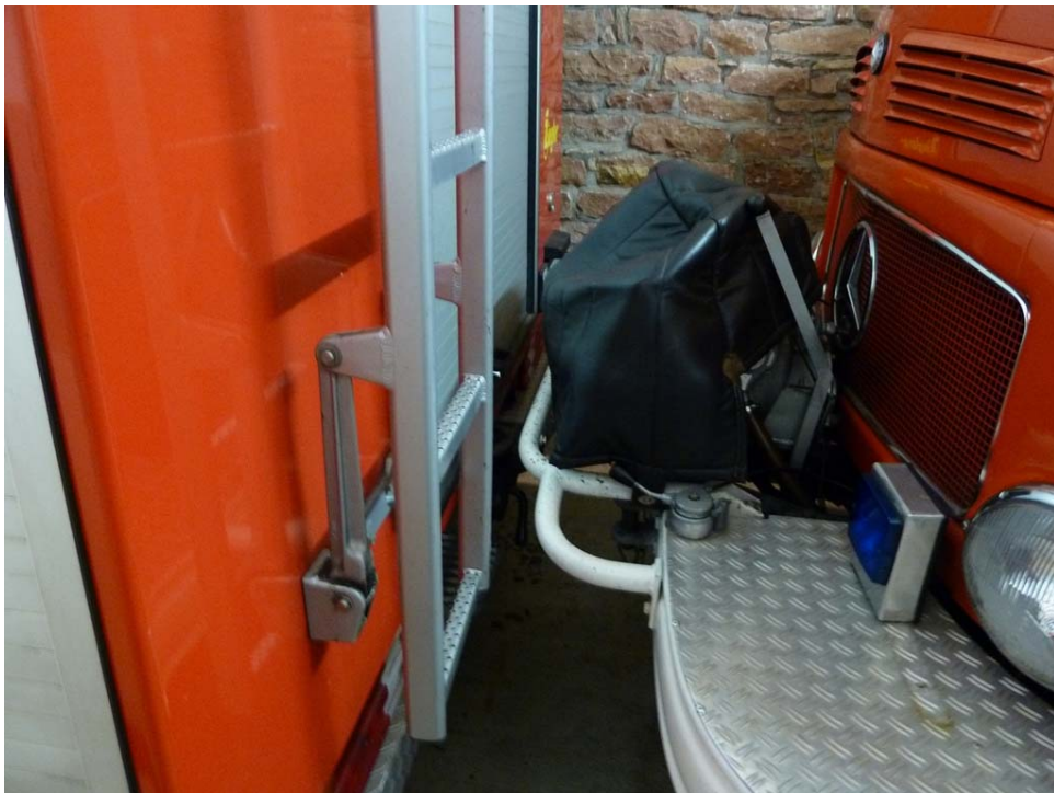
Bild 6: Abstand kleiner 20cm zwischen den abgestellten Fahrzeugen
