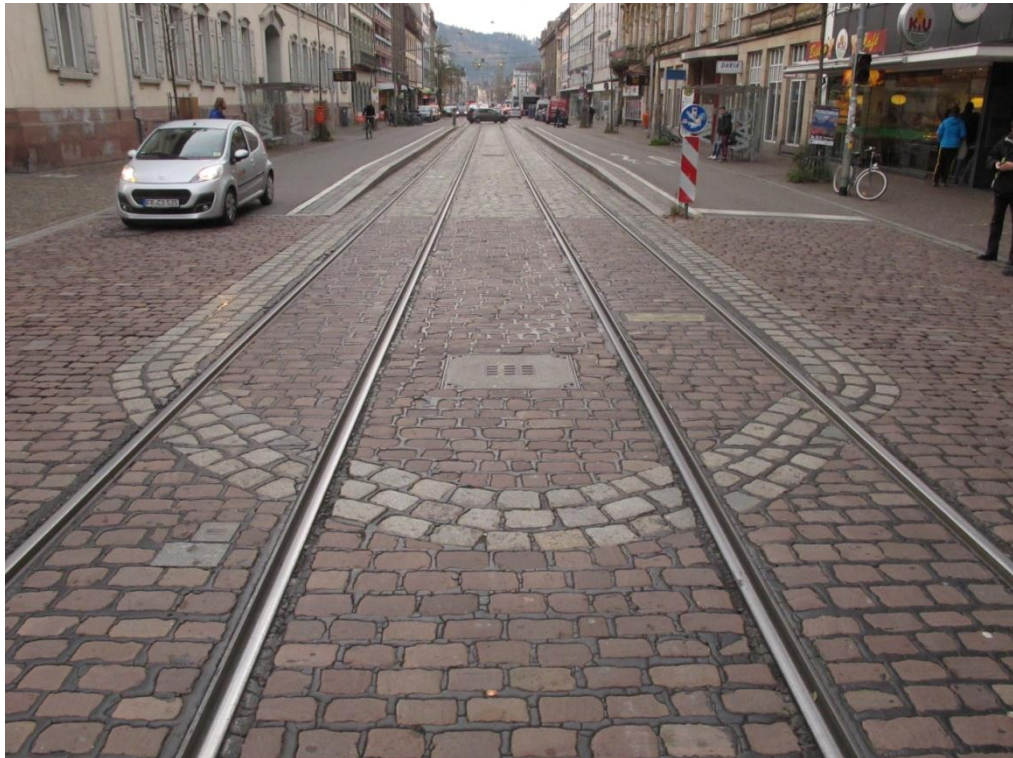
Abbildung: Haltestelle mit angehobener Fahrbahn Beispiel Freiburg
