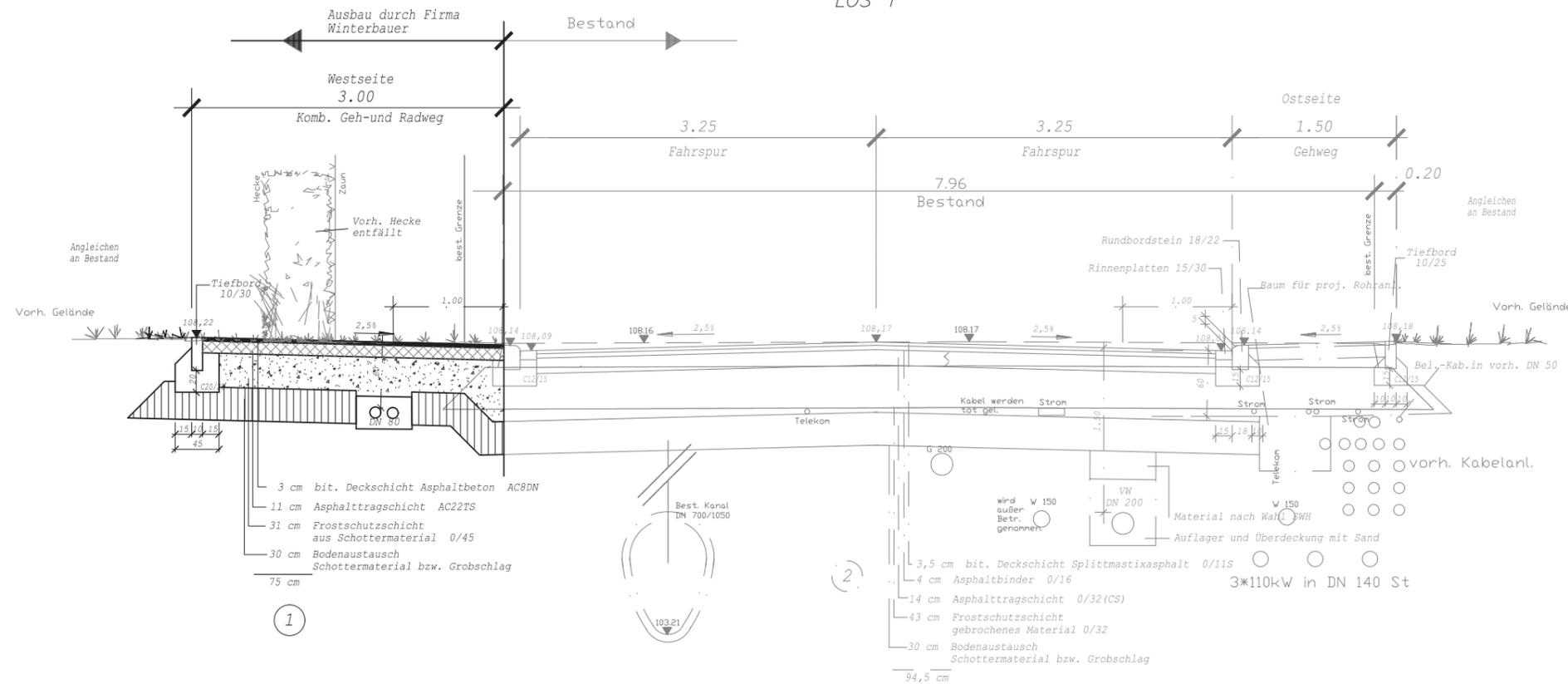
Die Anschlüsse der Straßenabläufe sind alle DN/OD 160 PVC-U, SN 12
