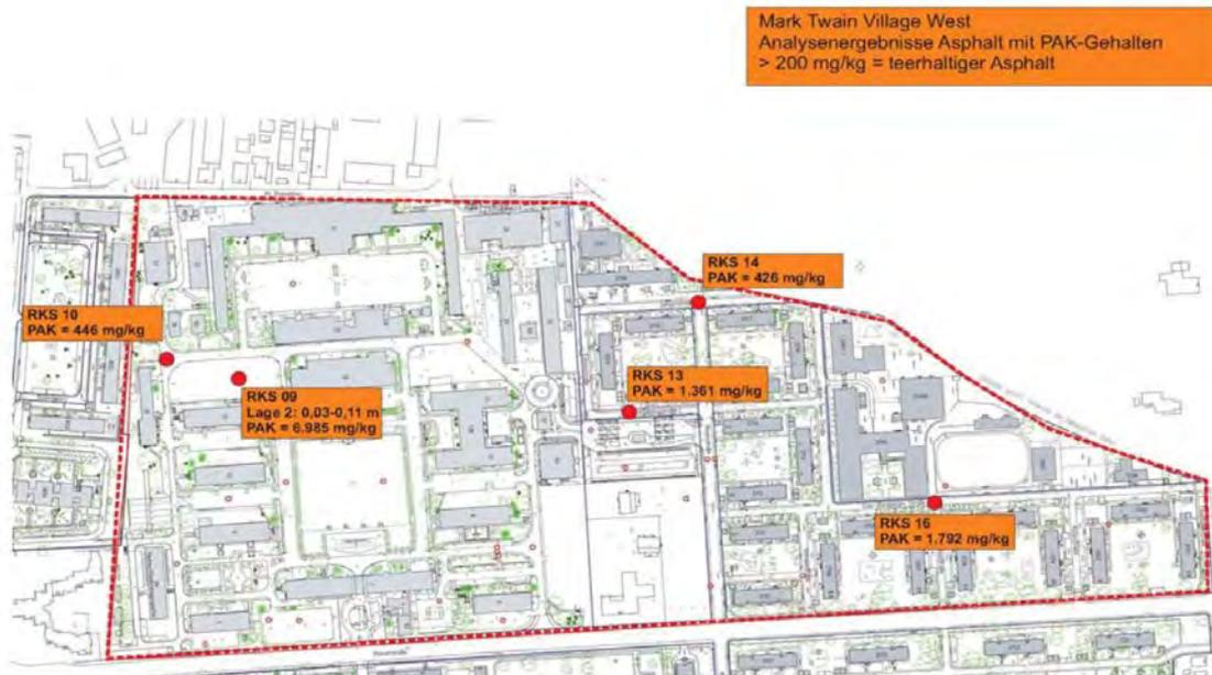
Abbildung 2: Lage der Untersuchungspunkte im Konversionsgebiet mit teerhaltigem Asphalt
