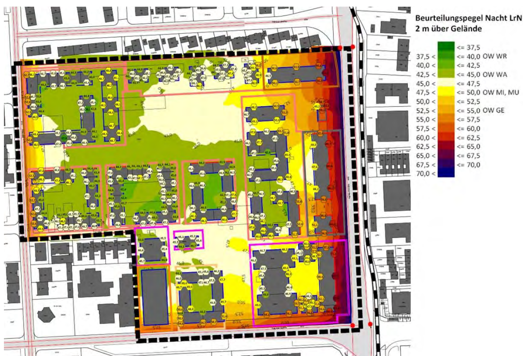
Abbildung 6.6-2. Ausschnitt aus der Karte "Verkehrslärm im Plangebiet (Straße und Schiene). Nacht 22:00-06:00 Uhr. Bestandsgebäude und beispielhafte Bebauung gemäß Rahmenplan. Rasterlärmkarte 2 m über Gelände und höchster Pegel an den Gebäuden." (WSW Partner GmbH 2019). Legendenelemente verschoben.
