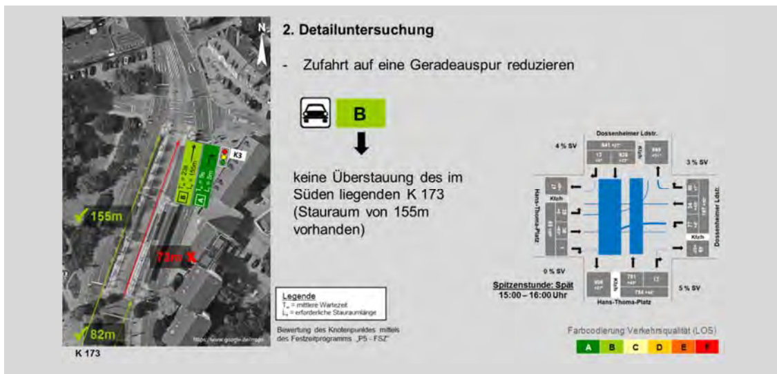
Abbildung 3.15: 2. Detailuntersuchung K174 – südliche Zufahrt
