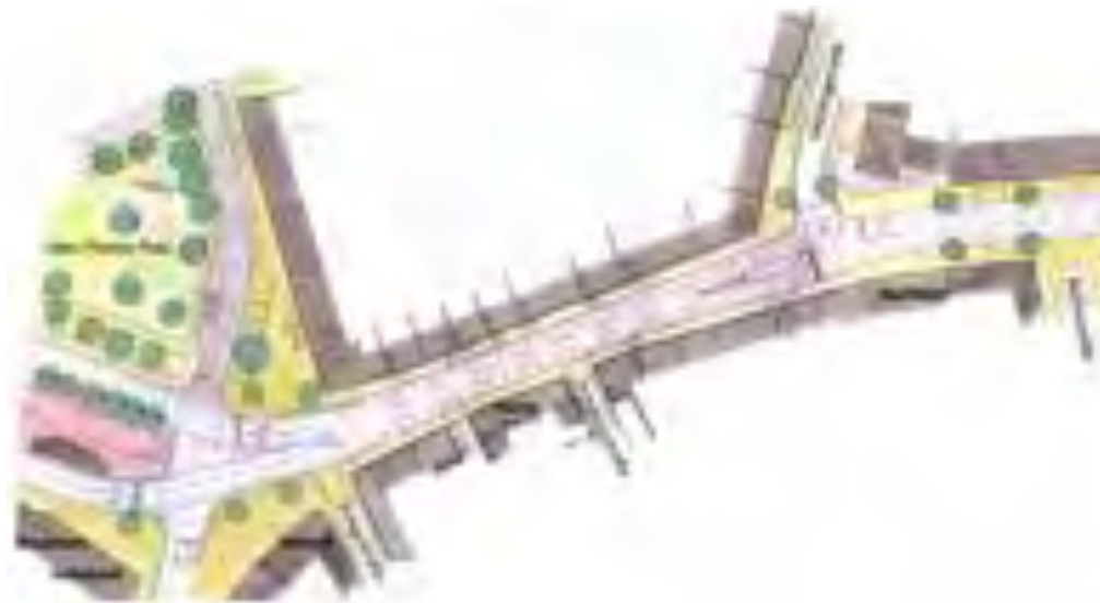
Abb. 193: Engstelle und Knoten Mühlingsstraße – Es sind keine Lieferplätze vorgesehen, weswegen Behinderungen für den Radverkehr zu erwarten sind. Die FLSA an der Mühlingsstraße sollte leicht nach Norden geschoben werden. Baumreihen sind nicht möglich, da die Gehwege zu schmal sind.
