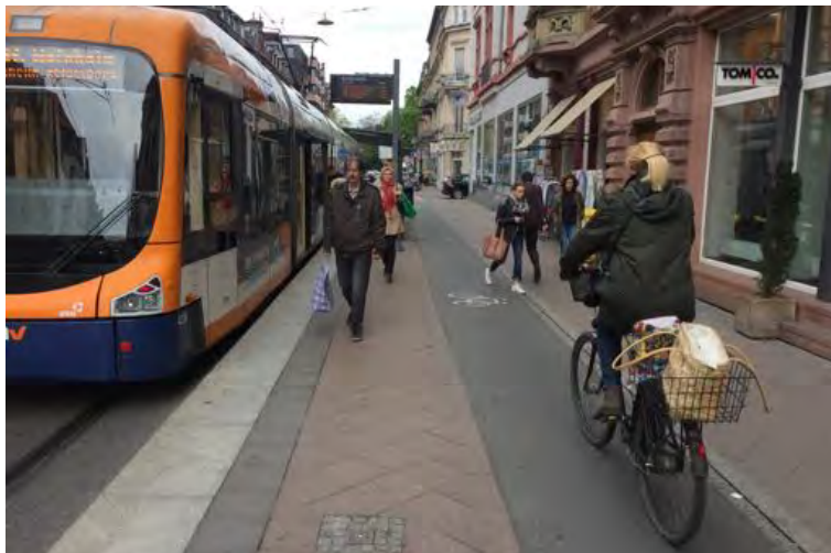
Abb. 75: Haltestelle mit Radverkehrsführung im Seitenraum. Diese Lösung ist bei hohen Nutzungsintensitäten und Flächenknappheit im Allgemeinen nicht empfehlenswert.
