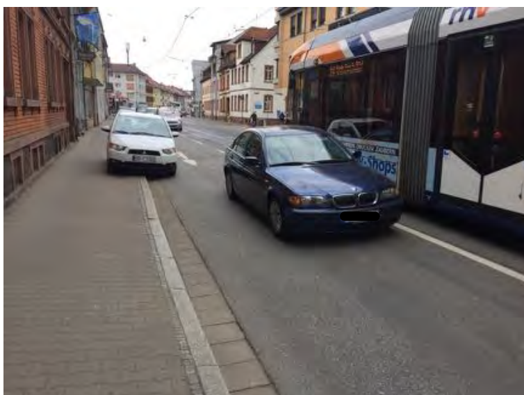
Abb. 40: Die Fahrbahnbreite erlaubt grundsätzlich ein Vorbeifahren von Kfz-Verkehr und Tram. Durch das Parken ist dies aber nicht immer gegeben. Dadurch kann es auch zu Konflikten und Gefährdungen durch spontanes Ausweichen kommen.
