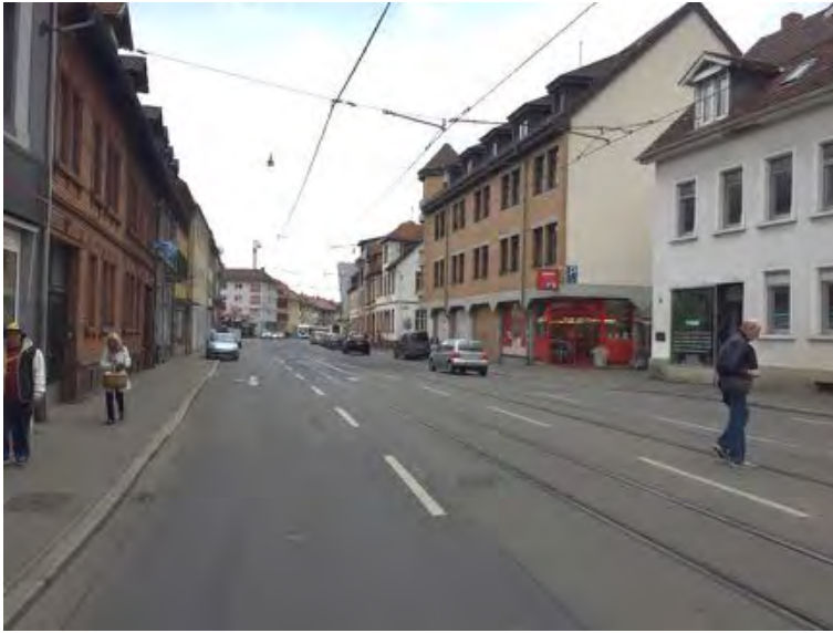
Abb. 15: Der südliche Bereich der Dossenheimer Landstraße mit einem Baufluchtenabstand von 16,5 m weist knapp vier Fahrspuren und enge Gehwege auf. Dennoch wird auf den Gehwegen geparkt bzw. geliefert. Funktionalität und Aufenthaltsqualität sind deutlich eingeschränkt, was gerade bei den Geschäften im Bereich ungünstig ist.
