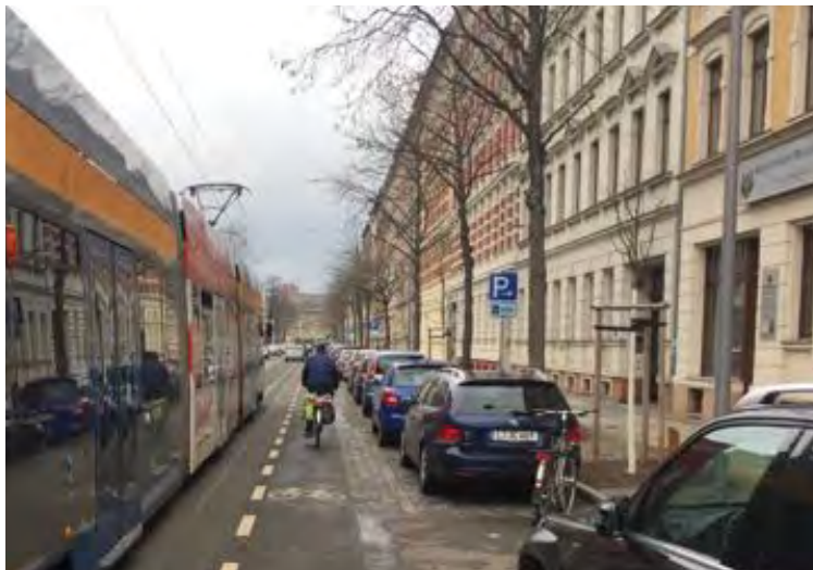
Abb. 120: Raumeindruck der Könnertitzstraße mit einem Schutzstreifen von 1,25 m Breite. Die Straßenbahn fährt im Bild an einem langsamen und unsicheren Fahrer vorbei.
