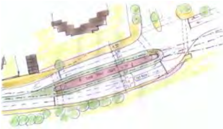
Abb. 148: Barrierefreier Ausbau mit Mittelbahnsteig und bestehender Wendeanlage.
