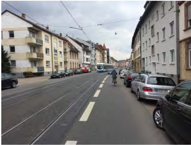
Abb. 38: Der Radverkehr weist keine eigenen Anlagen auf. Aufgrund der Breite der Fahrbahn und des Parkens auf dem Gehweg ist ein Vorbeifahren der Straßenbahn am Radverkehr möglich. Das Parken auf dem Gehweg geht jedoch zu Lasten des Fußverkehrs.
