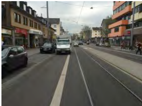
Abb. 71 Beispiel für den häufigen Missbrauch von breiten Radfahrstreifen (Breite ca. 1,85 m).
