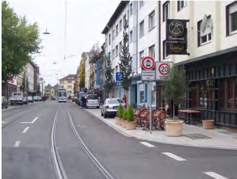
Abb. 96: Im Zentrum von Rohrbach handelt es sich um einen verkehrsberuhigten Bereich mit Tempo 20 und Nutzung nur durch Anlieger. Der Radverkehr kann auf dem relativ breiten Bereich (ca. 2.0m) zwischen Gleisen und Seitenbereich verkehren (unmarkiert). Da im Seitenbereich geparkt wird, sind die Gehbahnen sehr schmal.
