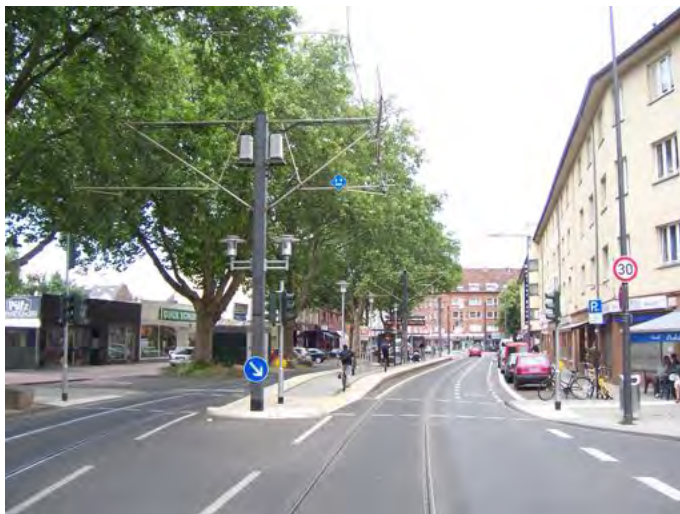
Abb. 108: Eine Haltestelle mit Mittelinsel erlaubt eine konfliktarme Führung des Radverkehrs und eine unproblematische Abwicklung der Grundstückszufahrten.
