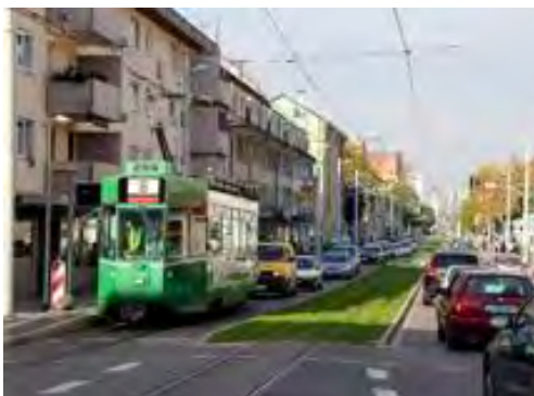
Abb. 128: Einfügen eines Rasenbahnkörpers ohne Berücksichtigung des Radverkehrs.
