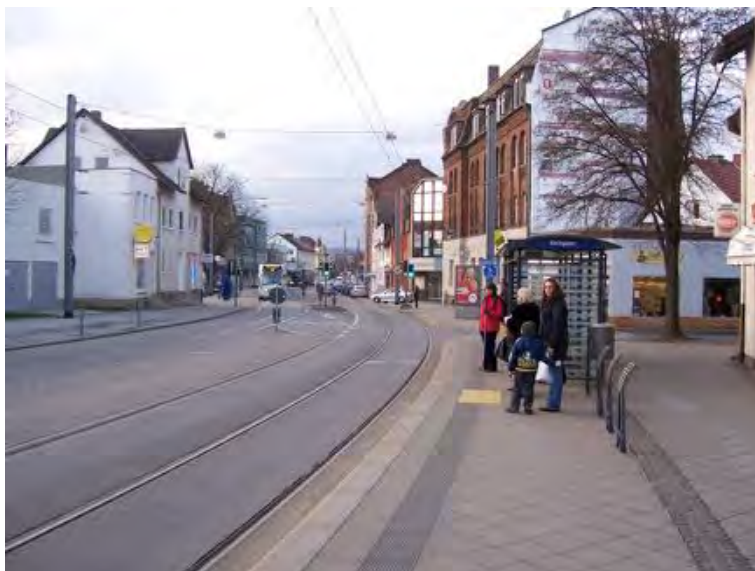
Abb. 104: Kassel, Leipziger Straße – Haltestelle am Fahrbahnrand ohne spezielle Radverkehrsführung und unterbrochener bzw. abgesenkter Bahnsteigkante
