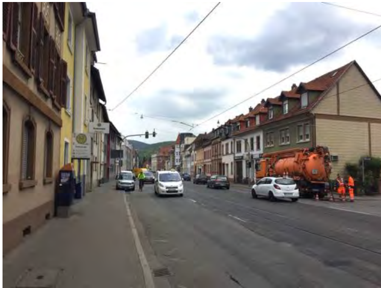
Abb. 18: Die Haltestelle Biethsstraße weist einen Einstieg von der Fahrbahn auf, welcher durch eine dynamische Zeitinsel (DZI) geschützt wird. Witterungsschutz und Sitzgelegenheiten für die Fahrgäste fehlen. Die Haltestelle ist nicht barrierefrei.
