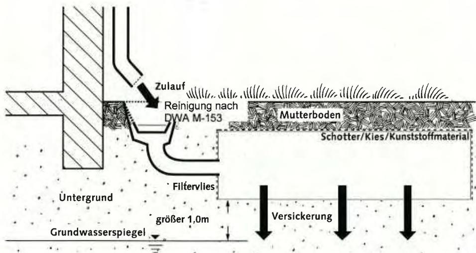
**Abbildung 12:** Systemschnitt Rigolenversickerung
