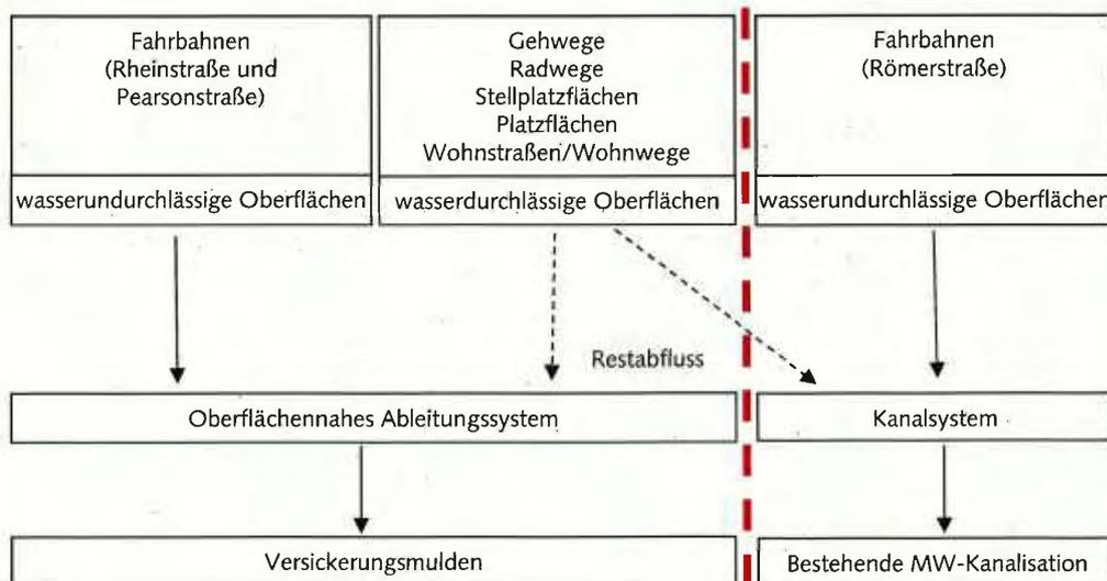
**Abbildung 13:** System zur Ableitung und Versickerung von Niederschlagswasser
