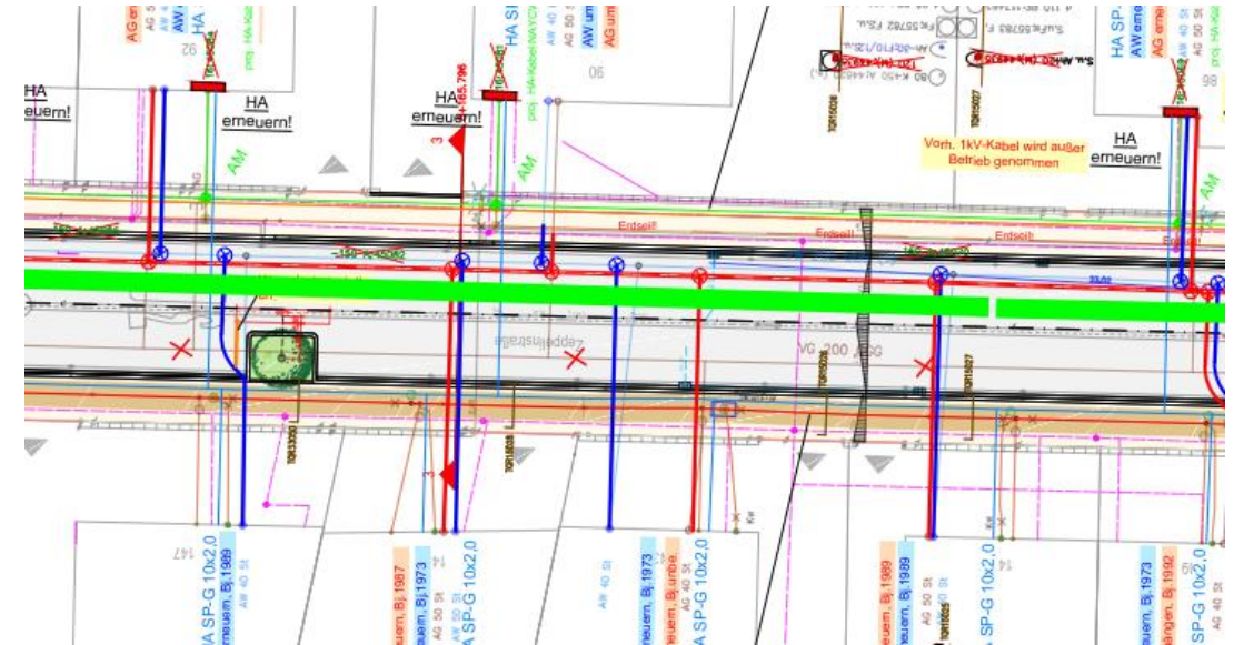
Bild: Exemplarischer Auszug aus der Grobtrassierung (grün - geplante Fernwärme)
